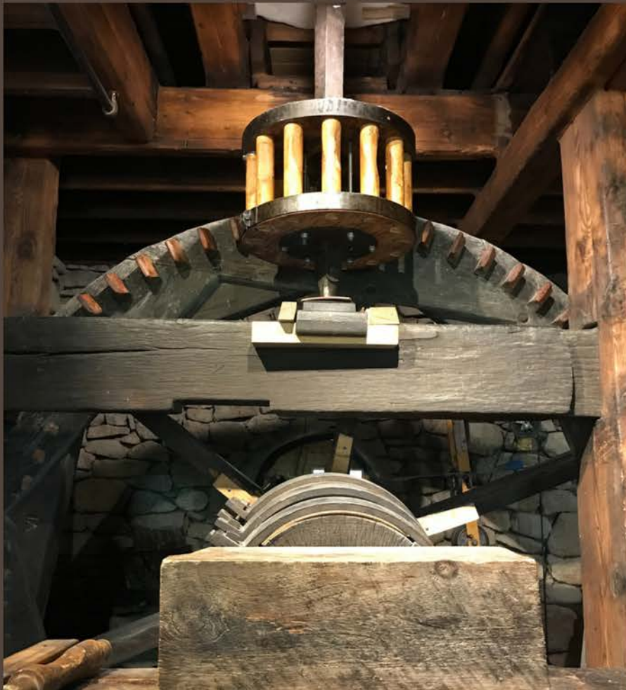
Getriebe der Plymouth Gristmill, MA - USA
